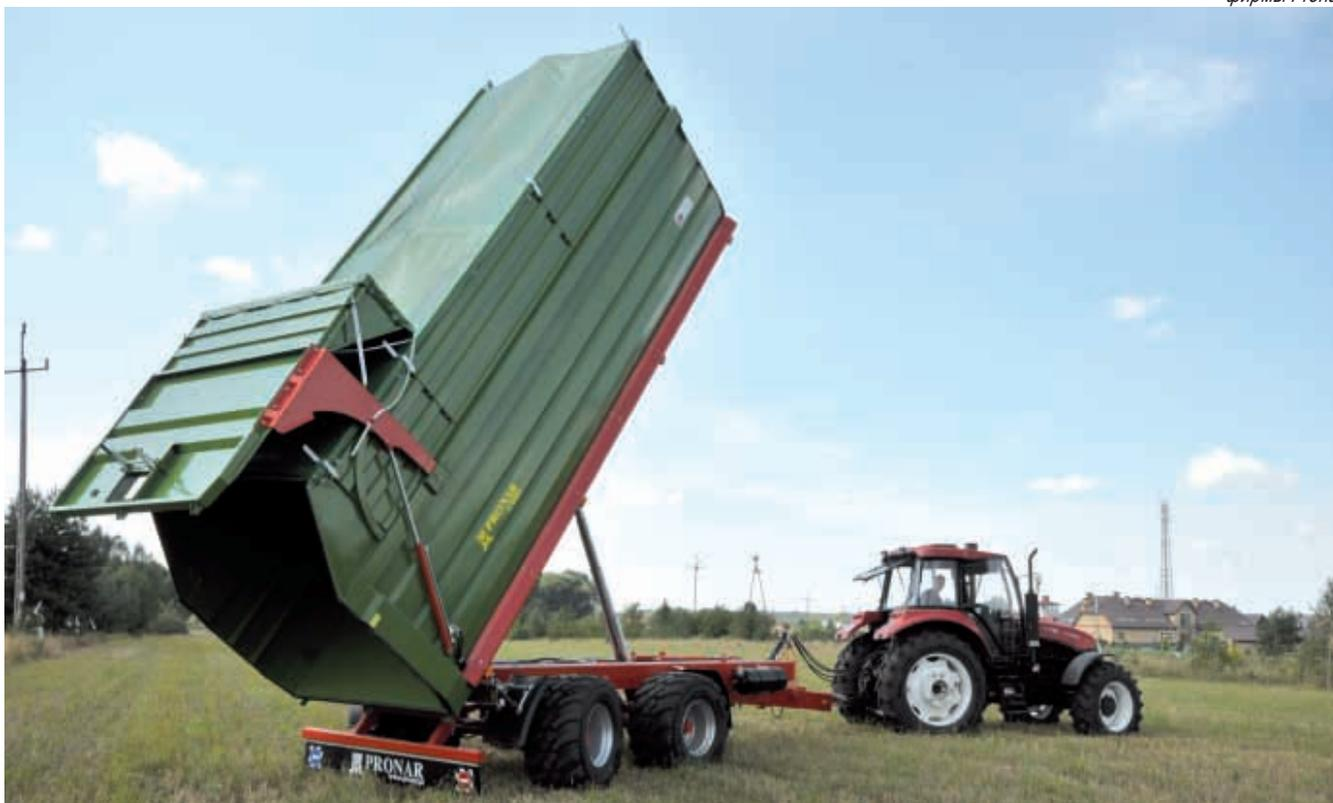
Боковая стенка платформы прицепа PRONAR T700M изготовлена из одного сплошного металлического листа, что делает ее еще более прочной
