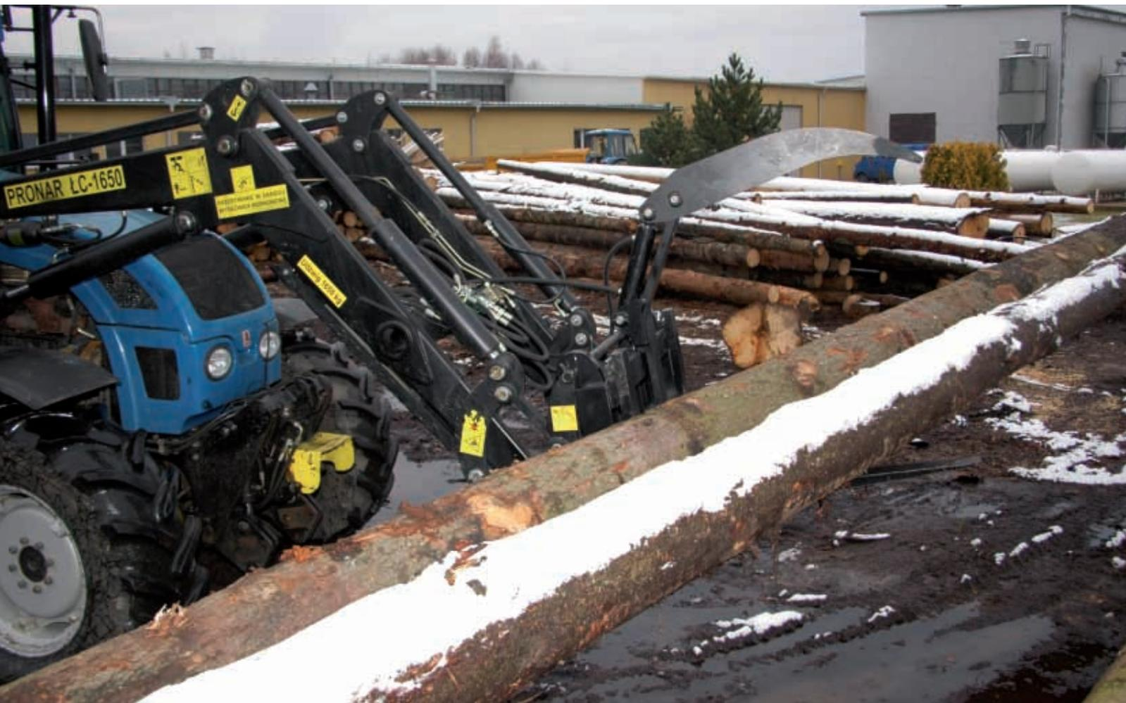
грузоподъемность составляет 2320 кг, высота подъема – 4117 мм, а собственная масса консоли – 526 кг. Комплектация погрузчика включает в себя систему амортизации консоли, третий контур гидравлической системы, управление с помощью джойстика, систему быстрого крепления рабочих инструментов, а также двустороннюю гидравлическую амортизацию. Погрузчик LC5 может работать со следующими тракторами:
