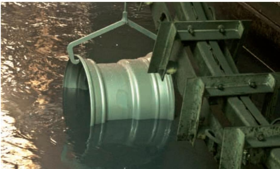
В процессе порошковой окраски применяется катафорез, обеспечивающий антикоррозионную защиту высокого класса.
