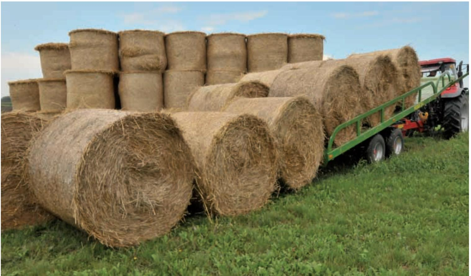
*Благодаря ширине грузовой платформы (2550 мм), мы получаем возможность погрузки рулонов в два ряда*
