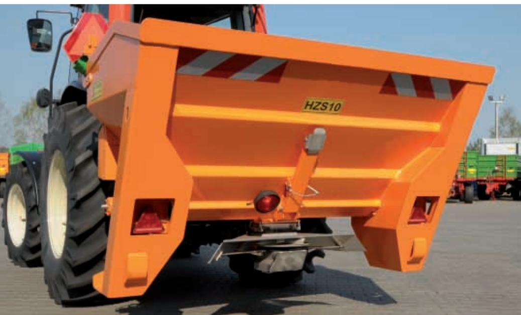
Наклоняемый ковш самогрузного разбрасывателя PRONAR HZS10 оператор наполняет, не выходя из трактора
