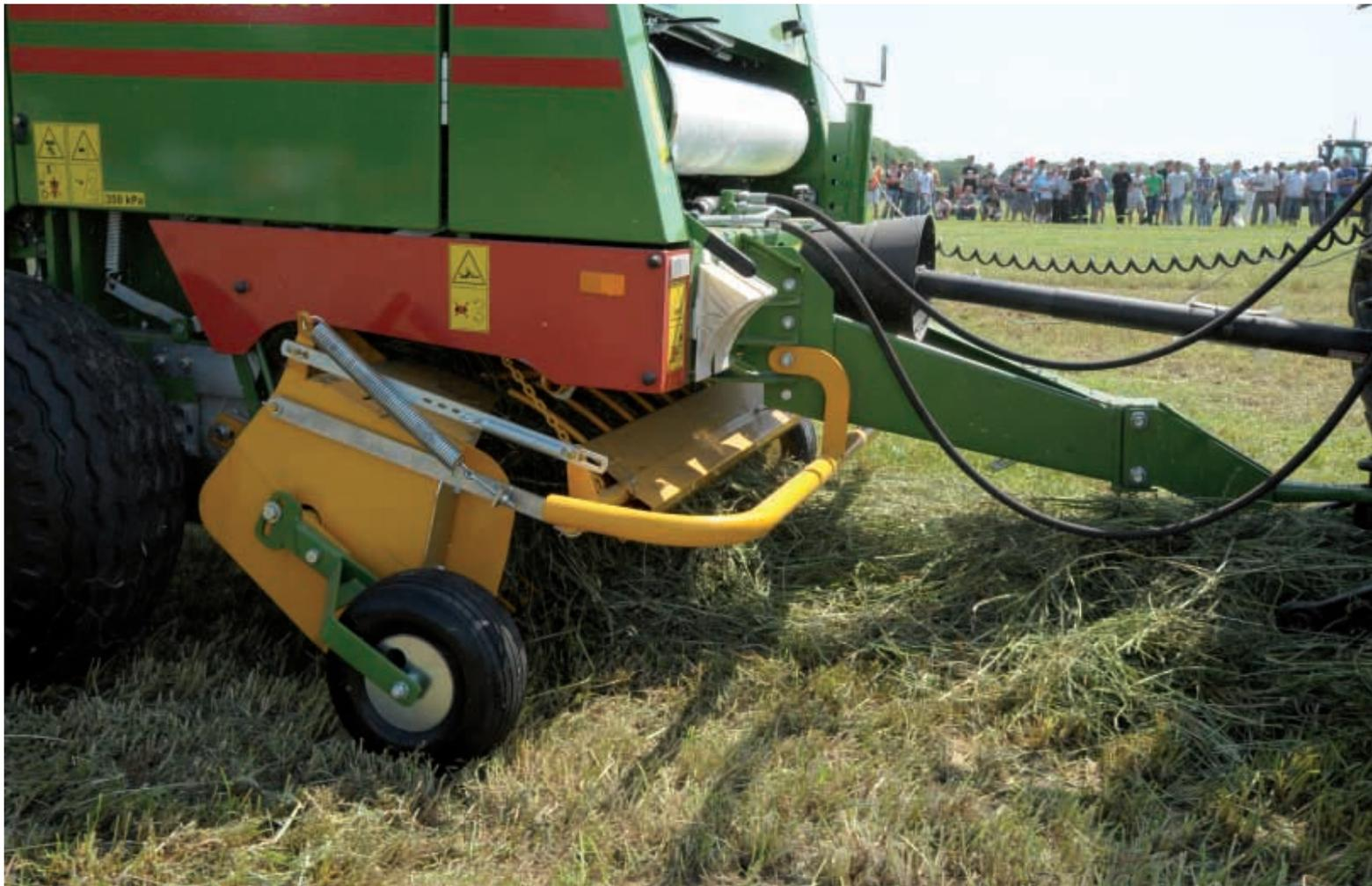
*Равномерно поданный слой материала обеспечивает рулон превосходного качества*
