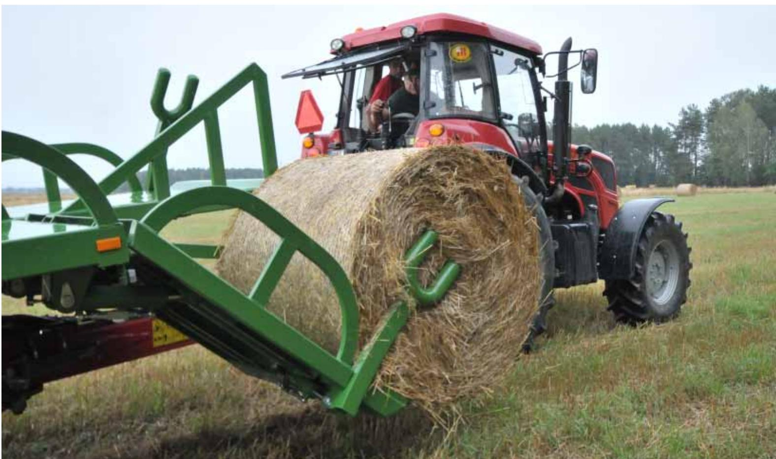
рулоны. В это время все находящиеся на платформе рулоны начинают скатываться в выбранное место складирования. Прицеп PRONAR TB-4 также имеет установленный в кабине трактора распределитель, что при выполнении погрузочно-разгрузочных работ позволяет координировать эти действия без необходимости выходить из трактора.
