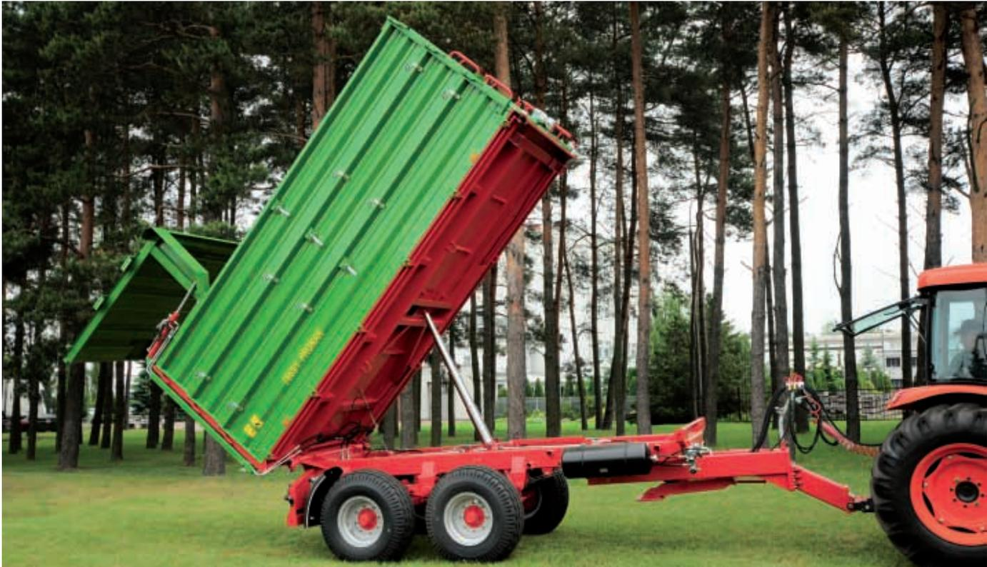
Некоторые модели прицепов, такие как 663/2, 663/1 (на фото) Т663/3, 663/4, Т683, имеют грузовую платформу трапециевидной формы, что облегчает разгрузку сыпучих материалов.
