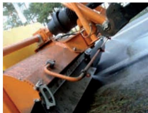
Поливочные сопла вместе с баком для воды значительно сокращают пылеобразование в процессе работы
