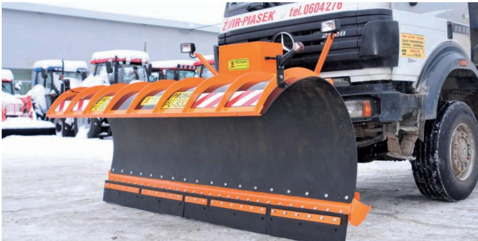
PU-S32H, установленный на грузовике
