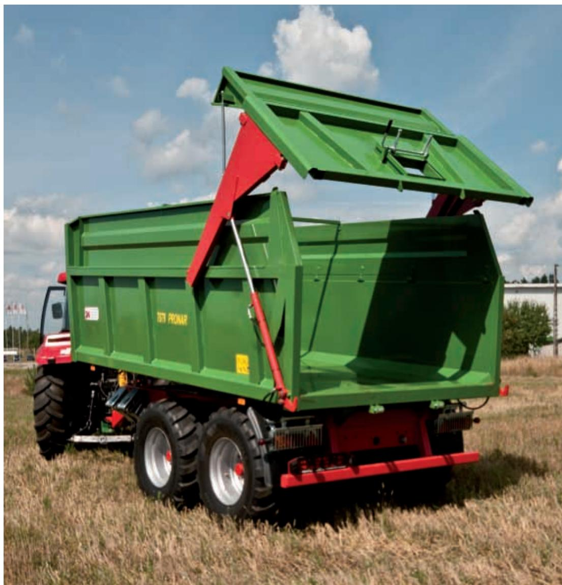
*Трапецевидная форма грузовой платформы прицепа T679 ускоряет и облегчает разгрузку*
