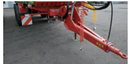
Шасси T400 – это система осей „тандем” на параболических рессорах, соединенная балансирами. Такая конструкция обеспечивает хорошую управляемость на дорогах общественного пользования, а задняя ось с пассивной системой поворота облегчает маневрирование.
