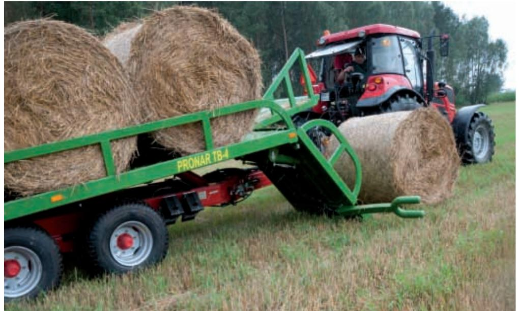
*Гидравлический механизм погрузки поднимает рулон и направляет его на прицеп*
