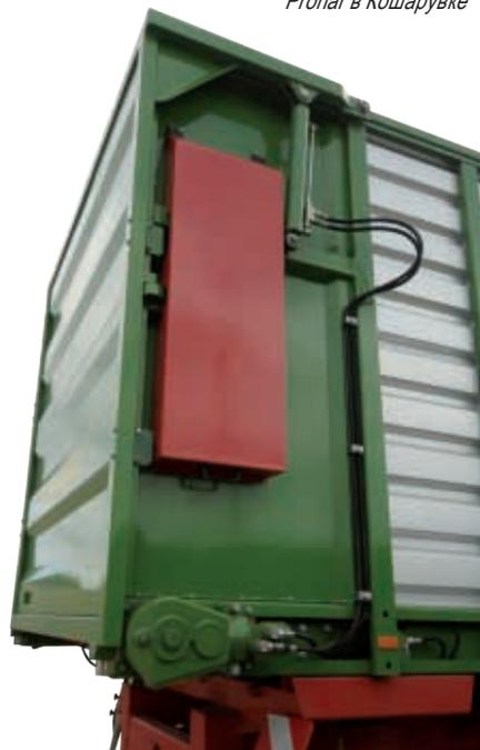
Стенки из стального листа с алюминиево-цинковым покрытием обеспечивают защиту от коррозии на долгие годы.
