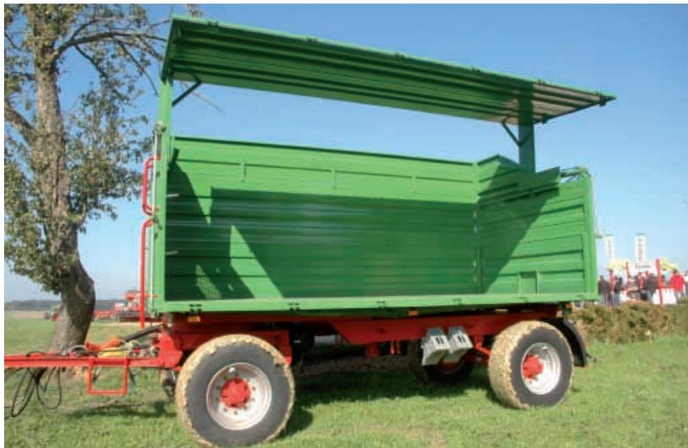
Прицеп PRONAR T680H – подъем боковой стенки с помощью гидропривода
