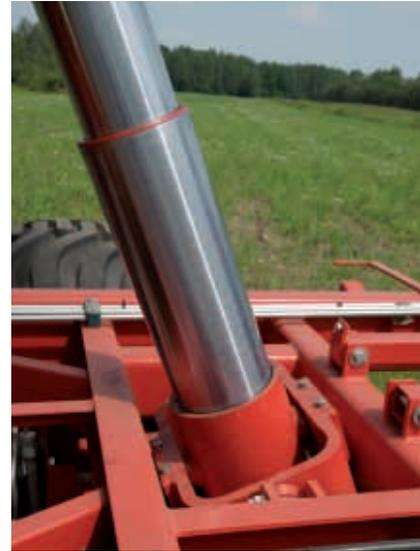
*Системы гидравлического опрокидывания прицепов PRONAR Т 679/2 и Т701 состоят из телескопических цилиндров с шарнирными петлями*
