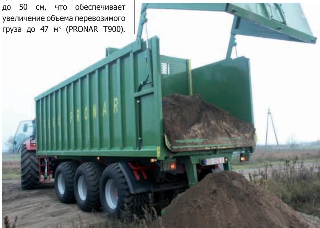
*В последней фазе разгрузки прицепа PRONAR T900 передняя стенка поднимается под углом 55 градусов*
