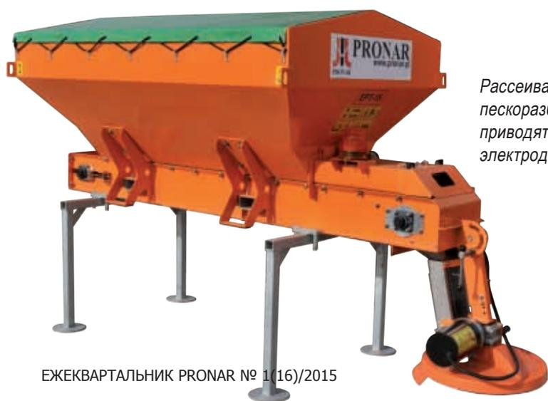
*Рассеивающий диск пескоразбрасывателя приводятся в движение электродвигателем*
