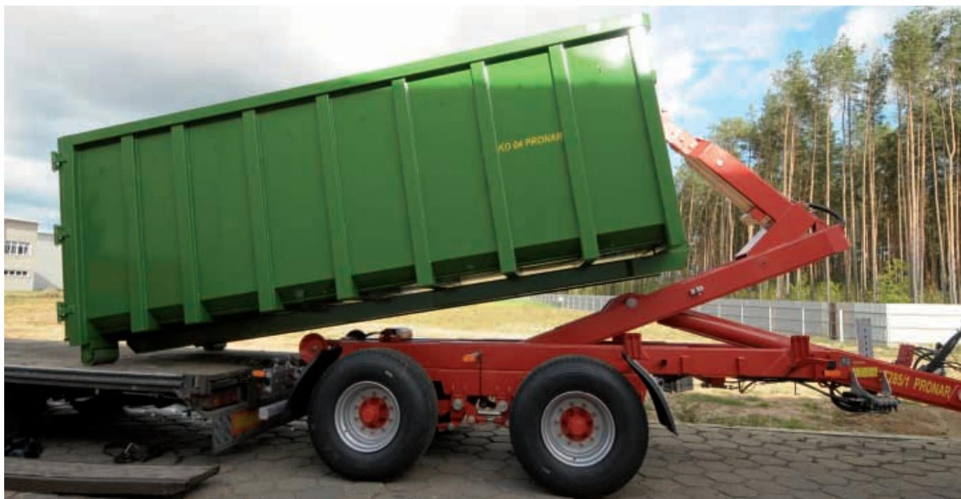
пассивным управлением. Это повышает маневренность и снижает износ шин. Во время заднего хода колеса задней оси блокируются в положении „движение прямо“ с помощью гидросистемы, которой управляет оператор из трактора.
